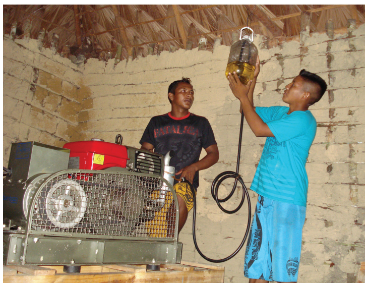
Escola Pamáali adapta motor para gerar energia elétrica a partir de óleo vegetal puro.
